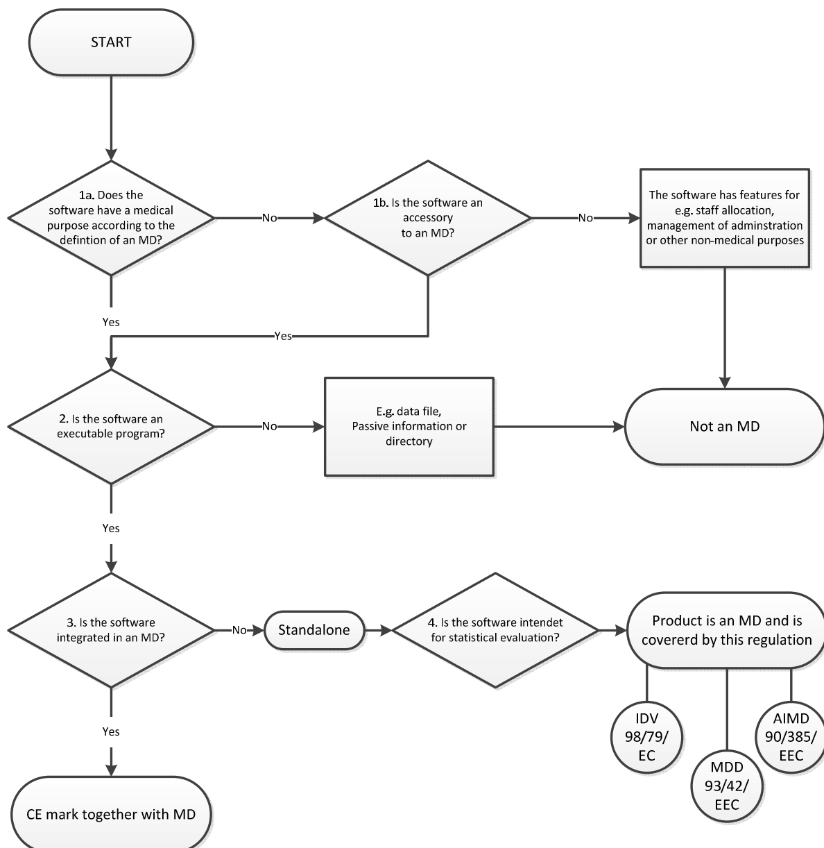
Abbildung 1: Entscheidungsbaum des schwedischen Leitfadens (Quelle 7)
